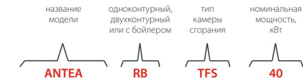
ПРИМЕР: котел ANTEA RBTF5 40 – одноконтурный котел со встроенным 3-ходовым клапаном и закрытой камерой сгорания на 40 кВт.
